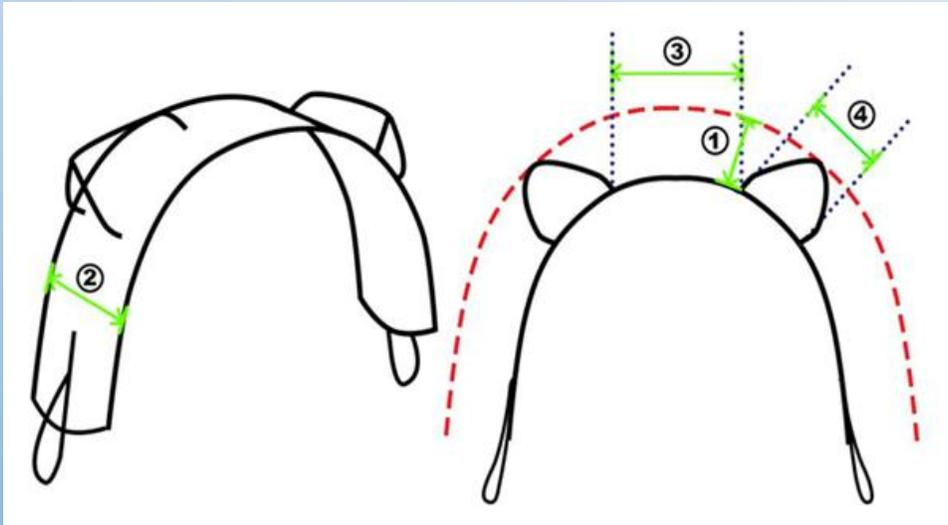
1. Максимальное расстояние, измеряемое от плоской поверхности гурты до внешней точки ручек, составляет 180 мм
