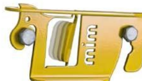
Флажок сгибается при усталости.
